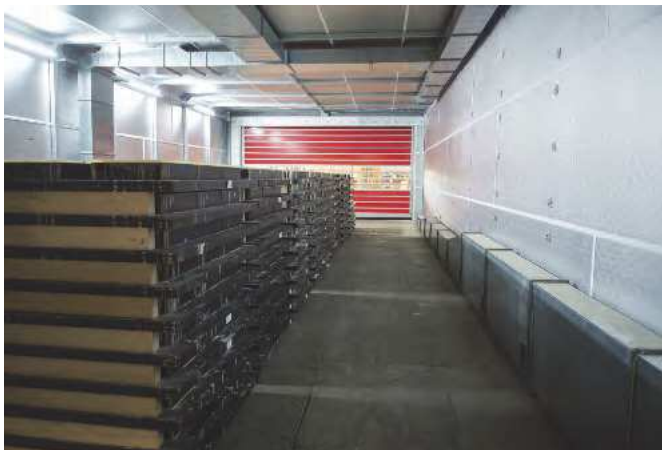
Jedna z dwóch komór dojrzewania w firmie Bachl, w których wyroby dojrzewają przed rozformowaniem.
