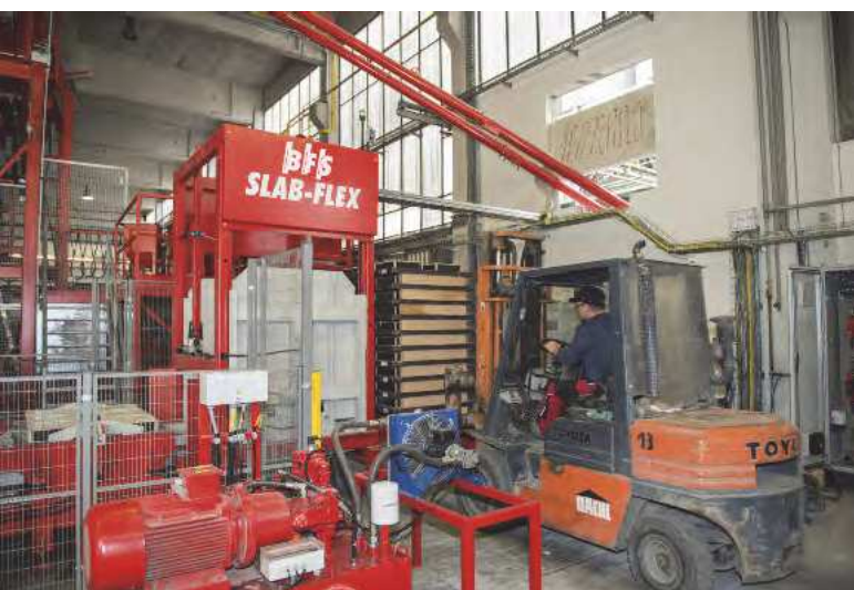
Rozładunek linii produkcyjnej za pomocą wózka widłowego.
